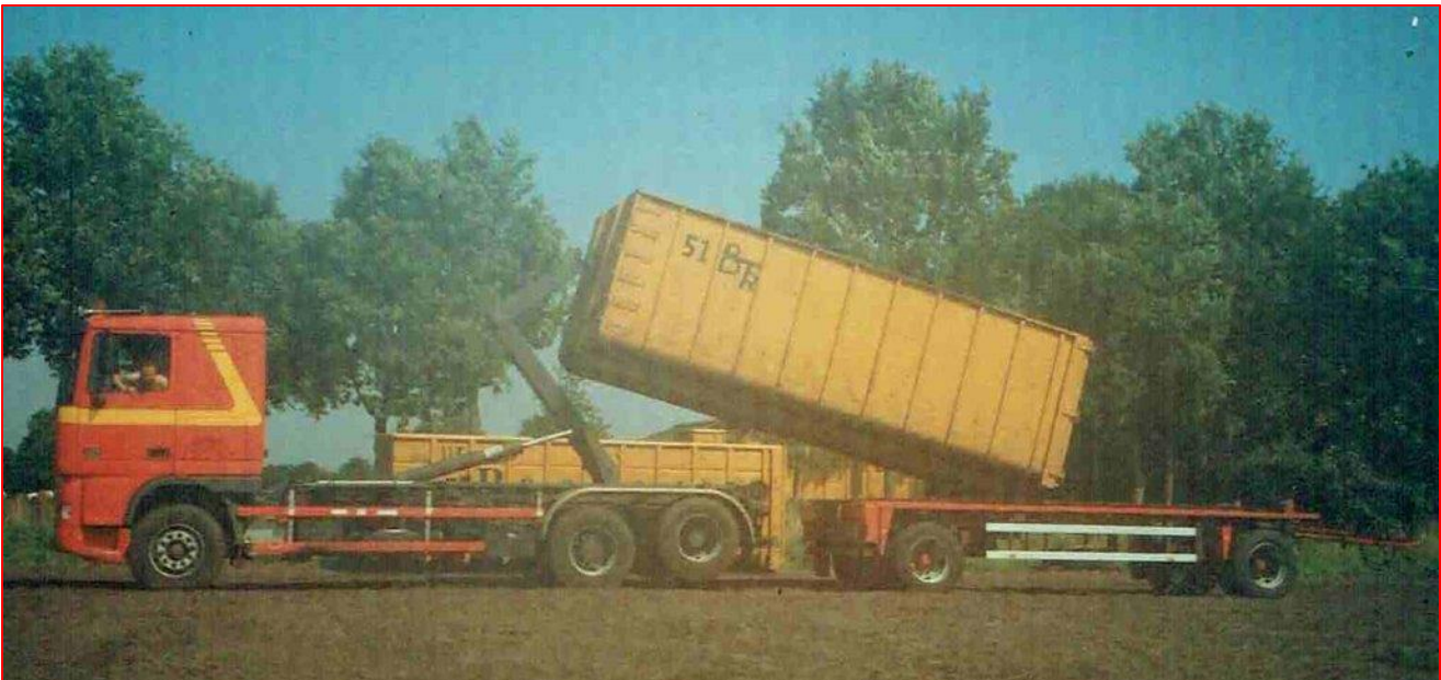
Boven; Overzetten van container op aanhanger met behulp van haakarmsysteem.
