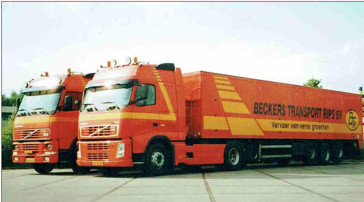
Links; Volvo autotrekker, met dichte opleggers met walking floor in de bedrijfskleuren van Beckers Transport.
